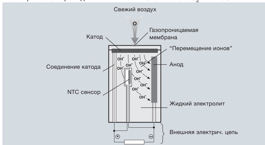
Рис. 21: Принцип работы кислородного сенсора
