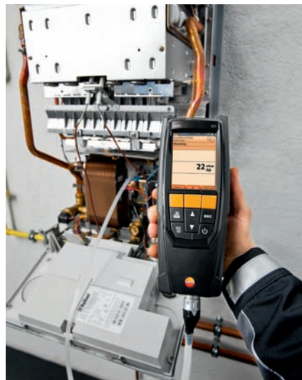
Рис. 15: Прибор testo 320 может использоваться как для анализа дымовых газов, так и для быстрого и точного измерения абсолютного и дифференциального давления.
