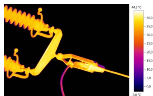
Тепловизионная съемка клеммного соединения изолятора (расстояние до объекта примерно 15 м)
